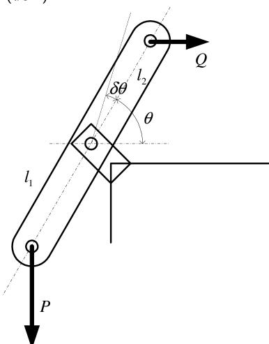
てこの支点をヒンジで支え、左端を鉛直下方へ P の力で引き、右端を水平右方へ Q の力でで引く。
