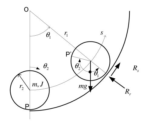
半径  $r_1$  の中空球内面を 半径  $r_2$  の小球が転がる。 小球質量 m、慣性モーメント J中空球中心を通る鉛直面内限定。
