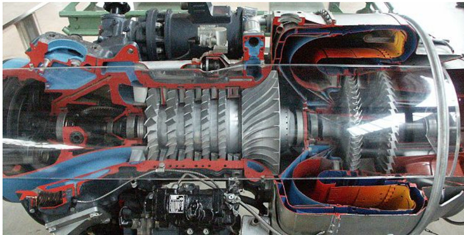
Fig. 329 航空機用ガスタービン (Lycoming 社 T 53 型ターボプロップ エンジン)
